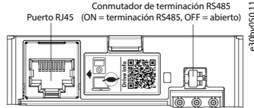
Ilustración 4: Puerto RJ45 y conmutador de terminación RS485
